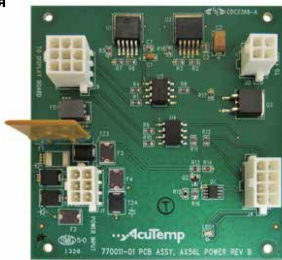
Мал. В-1. Панель живлення пристрою AX56L
