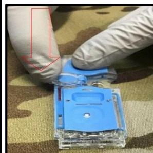
Мал. А5. Закриття картриджа
