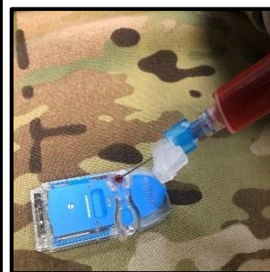
Мал. А3. Заповнення картриджа зразком крові
