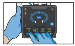
**REFINE** ventilator parameters.
