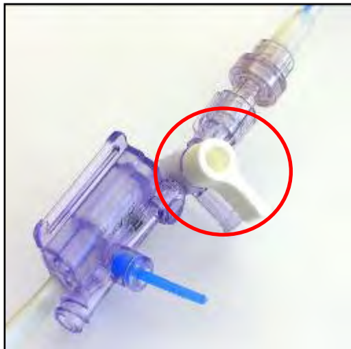
Рисунок 13-8. Запірний кран датчика в робочому положенні (горизонтально)
